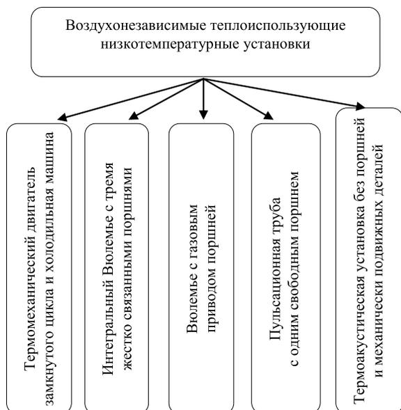
Рис. 4. Систематизация ВТНУ по типу машин
