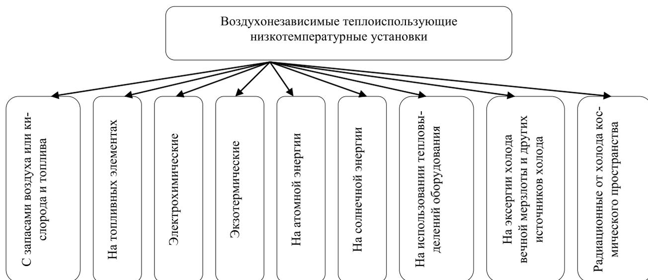
Рис. 2. Систематизация ВТНУ по типу подводимой энергии
