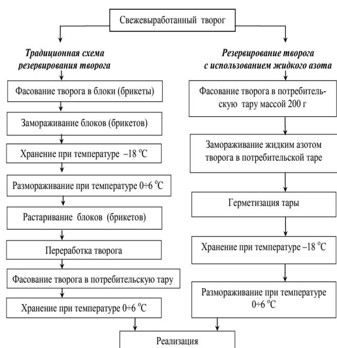
Рис. 1. Технологическая схема резервирования творога с использованием жидкого азота
