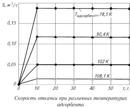
рительно охладив до ≈ 85 К. Перед измерением скорости откачки при той или иной температуре адсорбента его регенерировали. Регенерация заключалась в нагреве криопанели и камеры до 470 К и выдержке под вакуумом ( $10^{-1}$  Па) в течение 3 ч.
