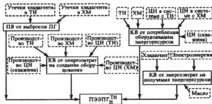
Рис. 2. Структурная схема потоков прямых и косвенных вкладов от выбросов парниковых газов в \text{ПЭЭПГ}_H^{\text{ТН}} . ХМ – холодильная машина; ЦН (ХМ) – циркуляционный насос, работающий в системе ХМ
