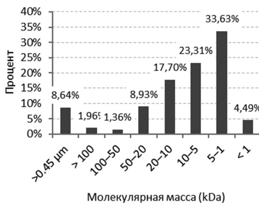
Рис. 1. Молекулярно-массовый состав водорастворимых фракций гидролизатов крабовых отходов, полученных: а — высокотемпературным гидролизом; б — ферментализом с применением алкалазы
