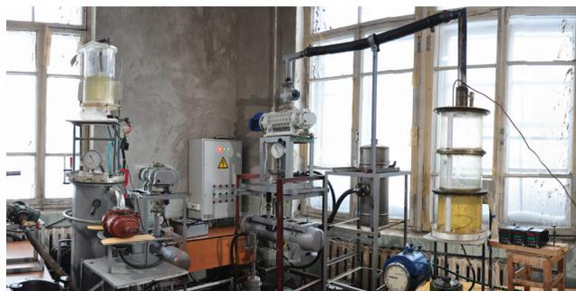
Рис. 7. Экспериментальный вакуумно-испарительный стенд, находящийся в лаборатории кафедры Техники низких температур им. П. Л. Капицы
