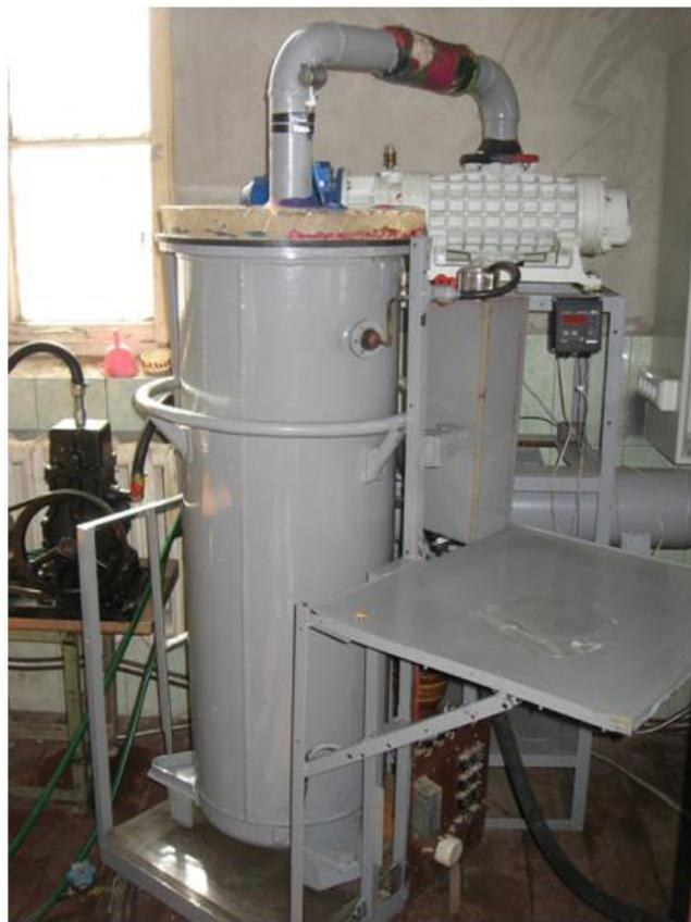
Рис. 9. Пилотный образец установки для производства бинарного льда находящийся в лаборатории кафедры Техники низких температур им. П. Л. Капицы
