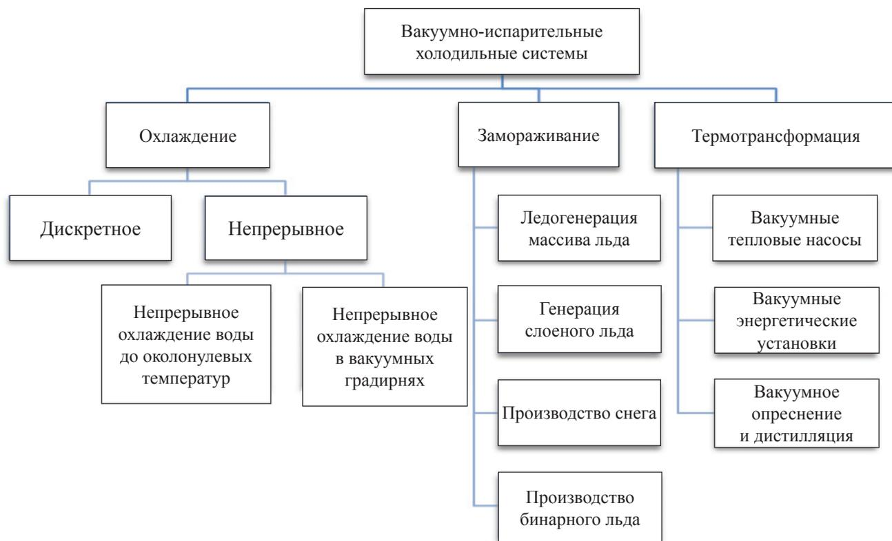
Рис. 3. Классификация вакуумных технологий получения низких температур
