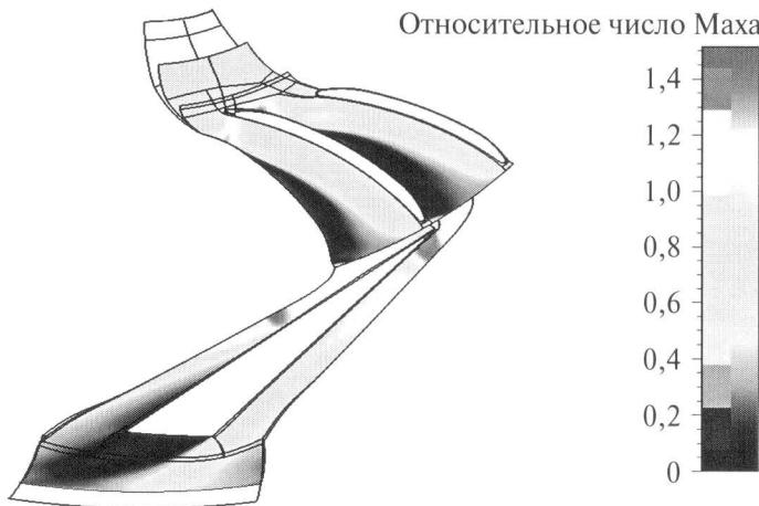
Рис. 1. Распределение относительного числа Маха по средней линии рабочей области при «запирании» рабочего колеса
