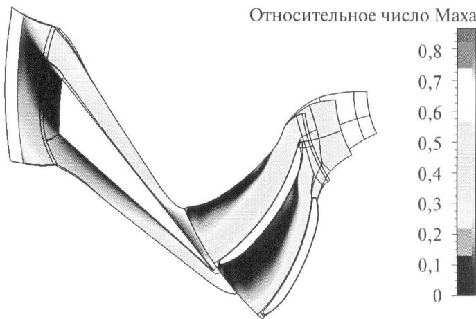
Рис. 2. Распределение относительного числа Маха по средней линии рабочей области при номинальном режиме работы
