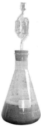
*Рис. 3. Лабораторная установка для сбраживания глюкозы в этанол*
