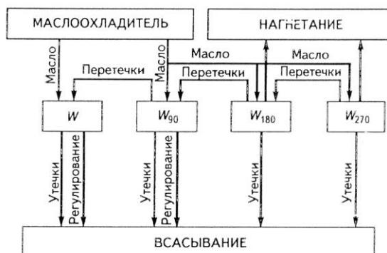
Рис. 1. Расчетная схема массового баланса парной полости винтового маслозаполненного компрессора
