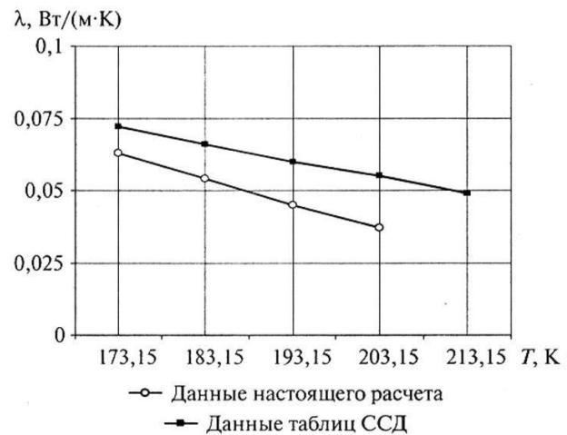
Рис. 2. Зависимость теплопроводности жидкого тетрафторметана от температуры
