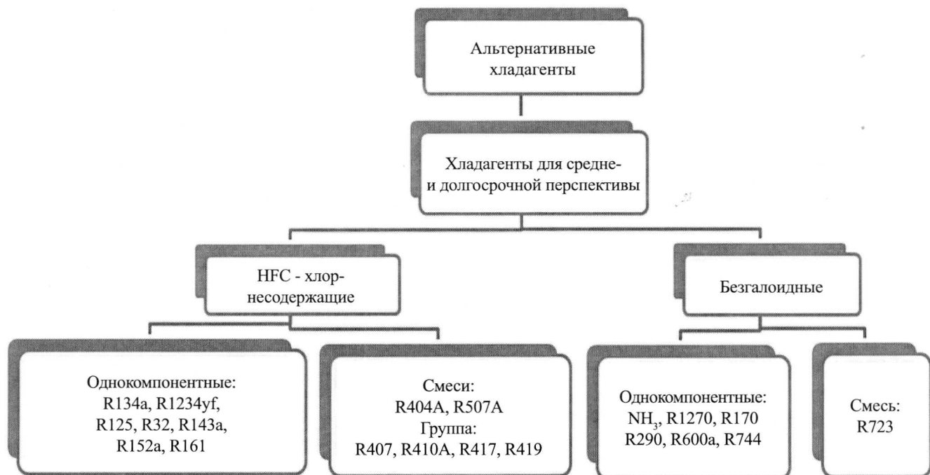
Рис. 1. Классификатор однокомпонентных и смесевых хладагентов с \text{ODP} = 0
