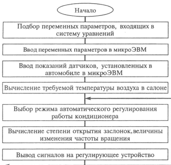
Рис. 3. Блок-схема алгоритма автоматического регулирования работы кондиционера
