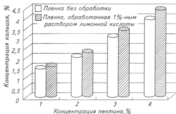
Рис. 1. Влияние на насыщаемость пленки ионами кальция концентрации пектиновых веществ и рН
