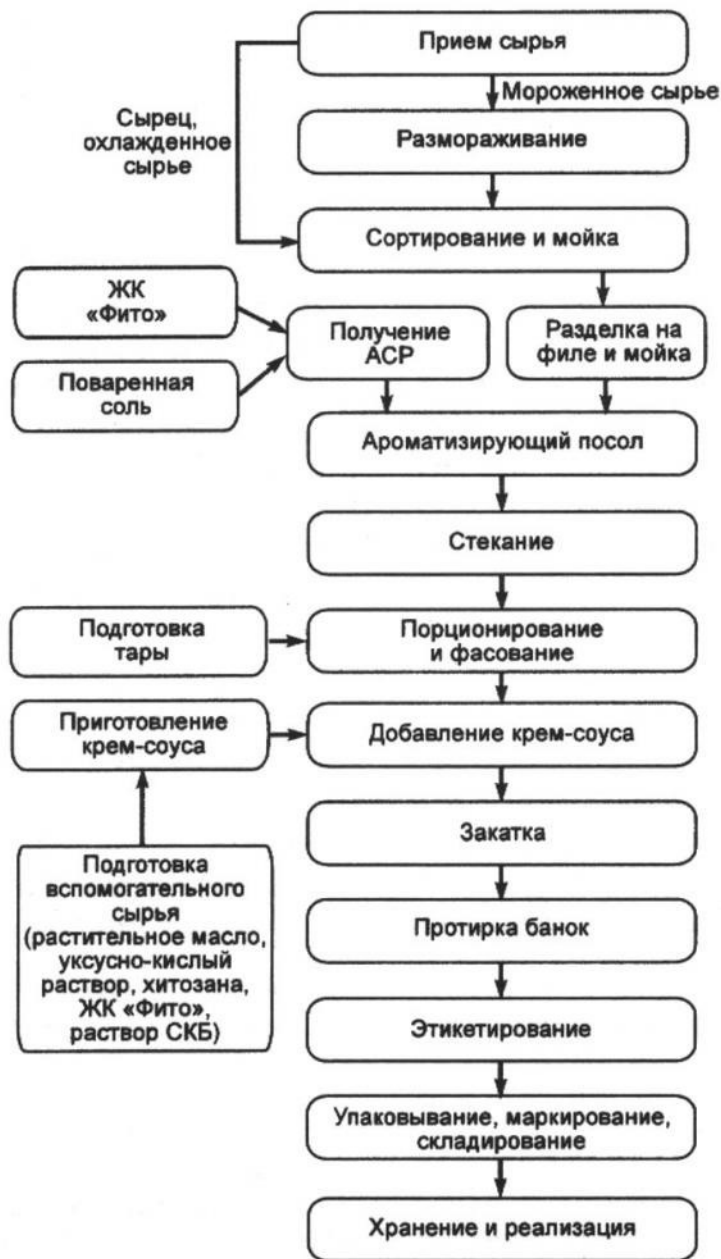
Рис. 1. Технологическая схема приготовления деликатесных пресервов в крем-соусе
