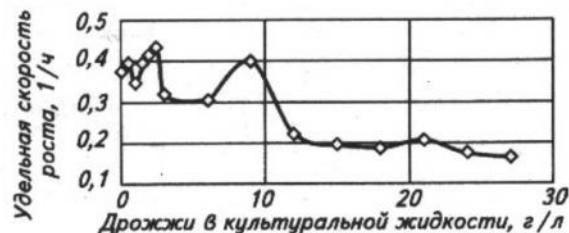
Рис. 3. Зависимость удельной скорости роста дрожжей от содержания дрожжей в культуральной жидкости
