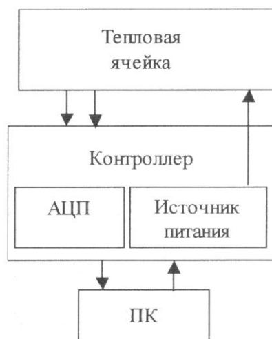
Рис. 1. Схема автоматизированной установки для измерения ТФХ в области фазовых переходов
