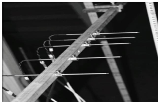
Рис. 2. Температурные датчики
