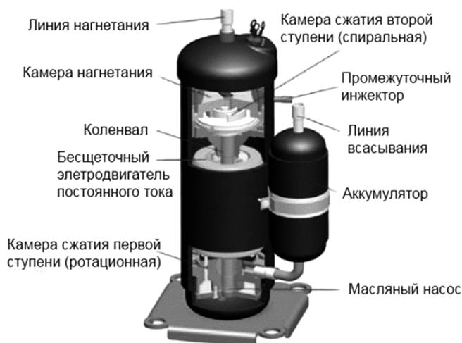
Рис. 2. Двухступенчатый спиральный компрессор на  $\text{CO}_2$
