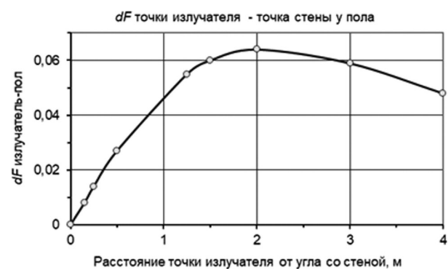
Рис. 9. Величина углового коэффициента на стене на уровне пола, точка X на потолке меняет свое положение, ось абсцисс Fig. 9. The value of the angle coefficient on the wall at the floor level, point X on the ceiling changes its position, the abscissa axis
