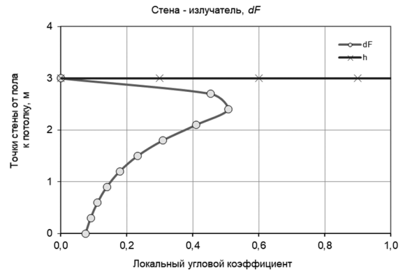
Рис. 6. Величина облученности всех точек стены по высоте h Fig. 6. Value of irradiance for all points of the wall along the height h
