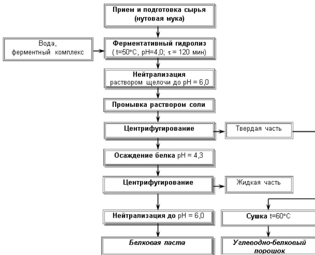
Рис. 5. Технология переработки нутовой муки с применением ферментативного гидролиза
