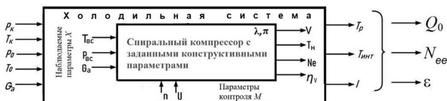
Рис. 3. Схема работы спирального компрессора в составе холодильной системы
