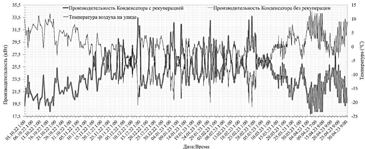
Рис. 3. Производительность конденсатора
