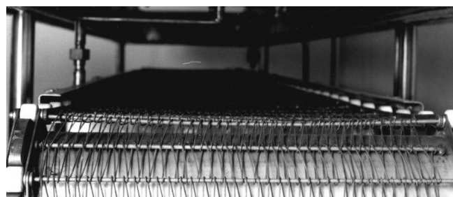
Рис. 2. Общий вид аппарата АСТА, конвейерной ленты и коллектора с форсунками
