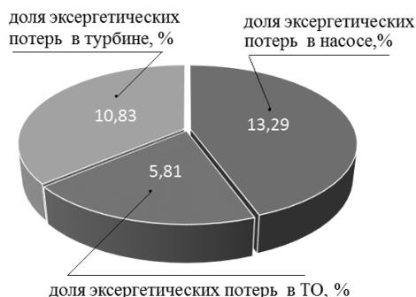
Рис. 3. Диаграмма потерь эксергии в элементах одноконтурной низкотемпературной энергетической установки
