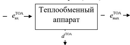
На выходе из насоса рабочее тело обладает эксергией, которая равна эксергии рабочего тела на входе в теплообменник (ТОА):  $e_{вых}^{нас} = e_{вх}^{тоа}$ .
