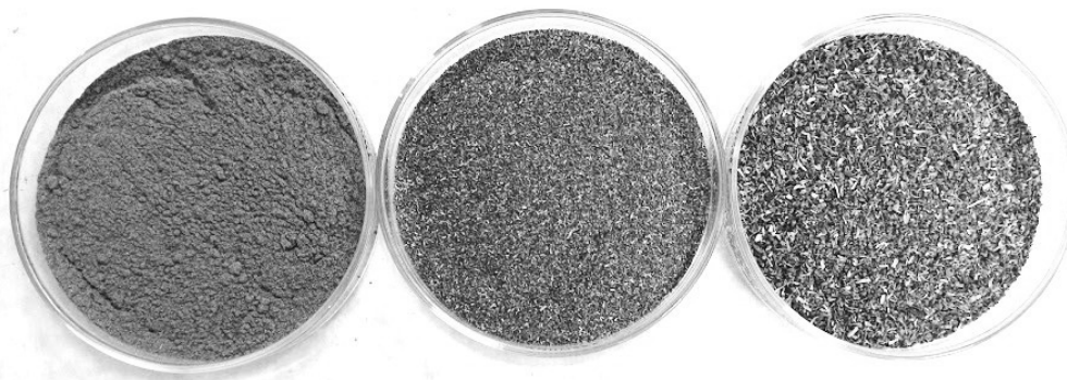
Рис. 2. Фракции, полученные после измельчения на кулачковой мельнице. Размеры частиц во фракциях, слева направо: менее 0,25 мм; 0,25–1,00 мм; 1,00–2,00 мм
