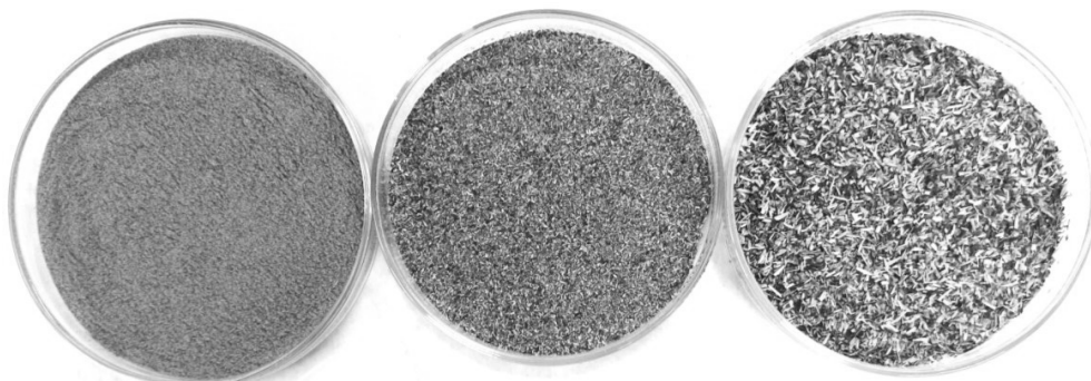
Рис. 1. Фракции, полученные после измельчения на роторно-ножевом измельчителе. Размеры частиц во фракциях, слева направо: менее 0,25 мм; 0,25–1,00 мм; 1,00–2,00 мм
