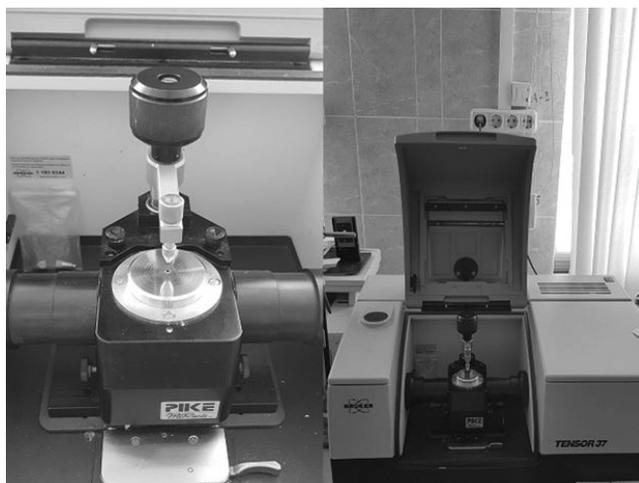
Рис. 2. IR spectrometer TENSOR 37 (Ge — кристалл)
