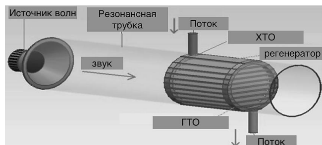
Рис. 3. ТАХ с динамиком в качестве источника акустических волн
