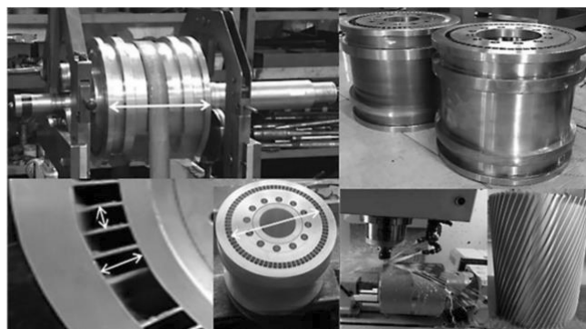
Рис. 12. Ротор волнового эжектора с профилированными каналами
