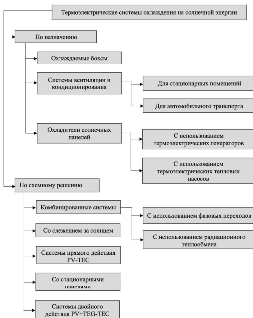
Рис. 2. Термоэлектрические системы охлаждения на солнечной энергии
