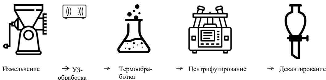
Рис. 1. Схема извлечения жира с применением ультразвука
