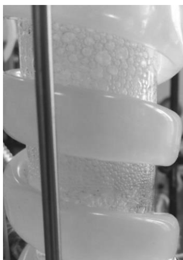
Рис. 4. Процесс пенообразования в двухфазной системе подсолнечное масло-азот
