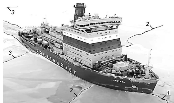
Рис. 4. Образование трещин в зоне контакта борта ледокола со льдом (1 — опережающая; 2, 3 — нормальные к борту текущие и предыдущие)
